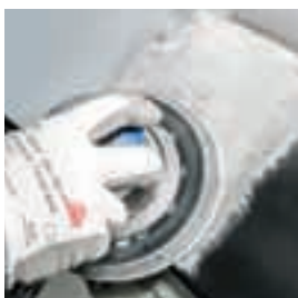
Шлифовка до гладкой поверхности
