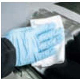
Очистка и предварительная обработка с помощью Teroson VR 20
