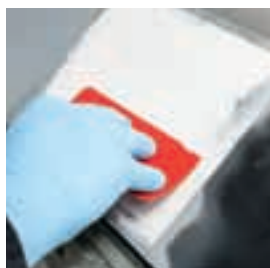
Применение мелкозернистой шпаклёвки Teroson UP 335 FF
